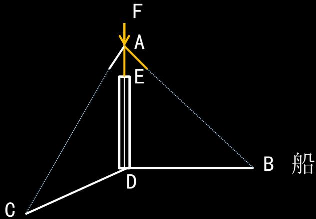
将该细竿调准到指向船的位置，然后转动FE，将细竿对准岸上的某一点C。则根据角边角定理， $DC = DB$
